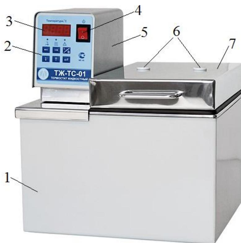
Рис. 7.2. Общий вид термостата: 1– ванна; 2 – кнопки установки температуры; 3 – индикаторное табло; 4 – кнопка включения сети.
