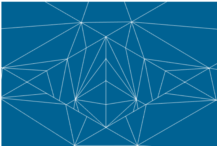
Рис. 74. Мелкое разбиение тетраэдрической сетки вблизи бруса.
