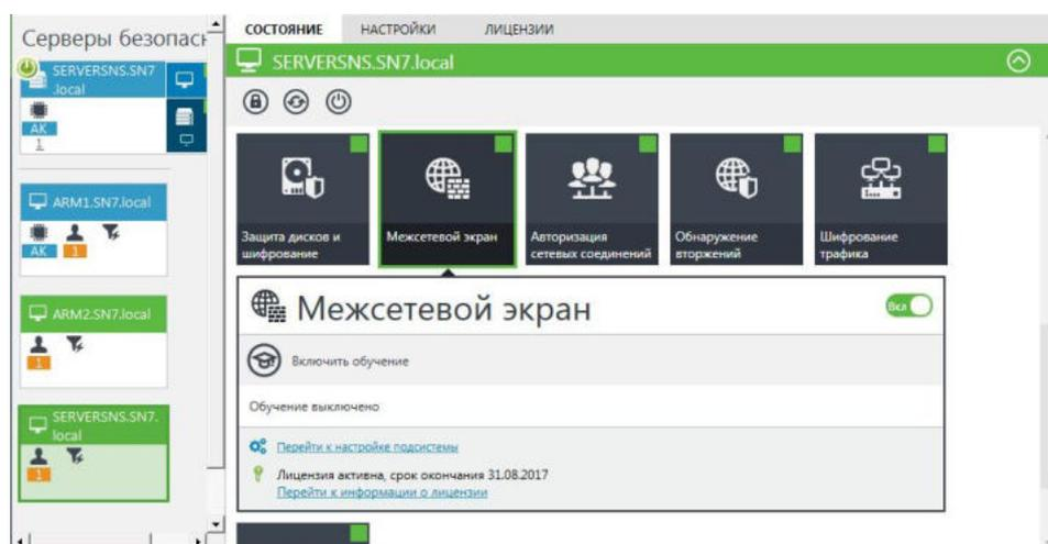
Обратите внимание, что данная вкладка позволяет включать/отключать на защищаемом компьютере работу компонента "Межсетевой экран", а также управлять работой режима обучения. Кроме того, с помощью кнопки-ссылки "Перейти к настройке подсистемы" можно перейти к настройке политик межсетевого экрана, с которыми мы познакомились в данной лабораторной работе.
