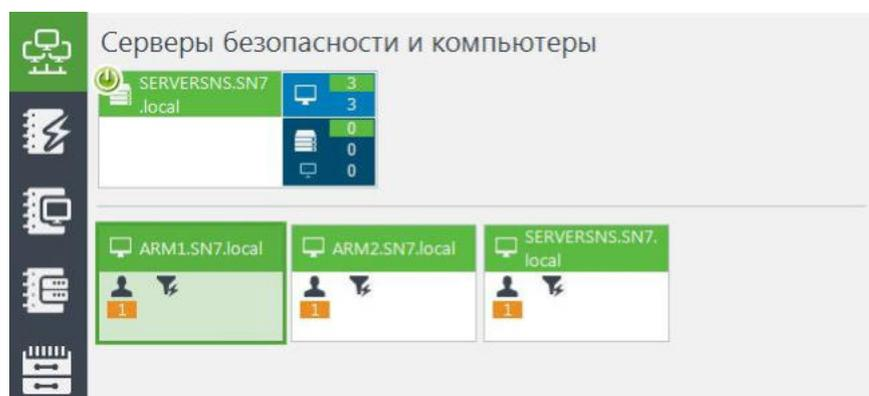
Если при установке серверов безопасности и клиентов выполнялось их подчинение СБ, эти компьютеры будут включены в структуру оперативного управления (ОУ). Структура ОУ считается сформированной на достаточном уровне, если все защищаемые компьютеры присутствуют в ней и подчинены серверам безопасности.
