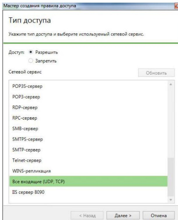
7. Установите параметры: "Доступ" – "Запретить", "Сетевой сервис" – "RDP-сервер". Нажмите кнопку "Далее". На следующем шаге мастера задаются параметры соединения. Их значения по умолчанию соответствуют выбранному на предыдущем шаге сетевому сервису.
