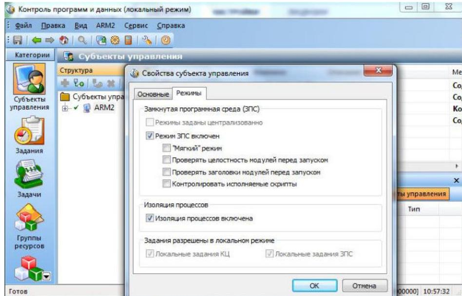
**15.** Для того чтобы ограничить пользователю user2 возможность вывода из ARM2 конфиденциальной информации на внешние носители или на печать, следует использовать настроенные ранее механизмы полномочного управления доступом, контроля устройств и печати при включенном режиме контроля потоков. Запустите программу "Пуск / Все программы / Код безопасности / Secret Net Studio / Настройка подсистемы полномочного управления доступом" и проведите дополнительные настройки:
