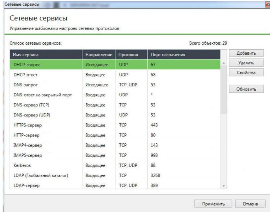
3. Просмотрите список сетевых сервисов – это шаблоны наиболее распространенных настроек сетевых протоколов. Добавьте новый сетевой сервис для доступа к серверу IIS по порту 8090 (в качестве этого сервера будет выступать сервер безопасности). Для этого нажмите кнопку "Добавить" и в открывшемся диалоговом окне заполните следующие параметры:
