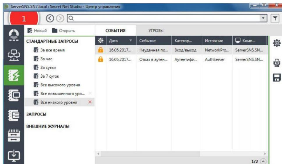
При получении уведомлений о произошедших событиях тревоги программа управления путем подачи различных визуальных сигналов незамедлительно оповещает об этом администратора безопасности.
