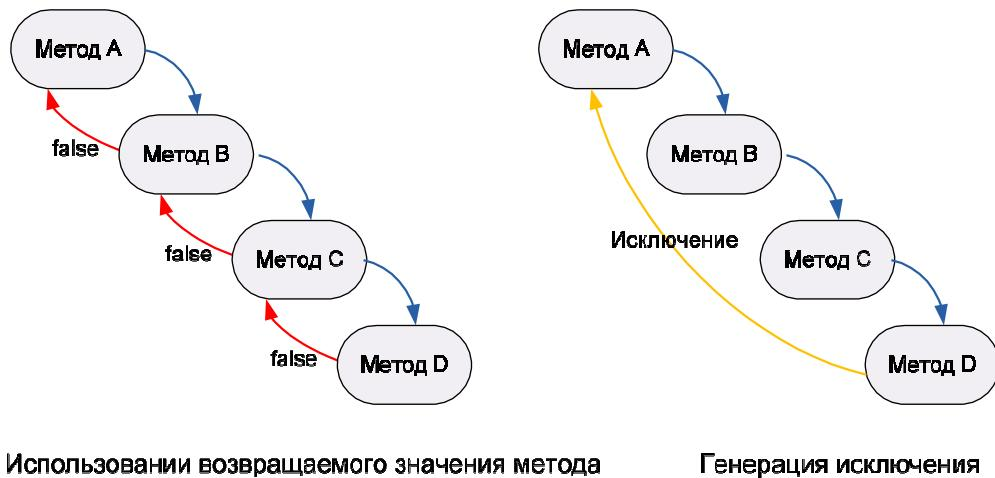
Рис. 2.9. Передача информации о возникновении ошибки по цепочке вызовов
