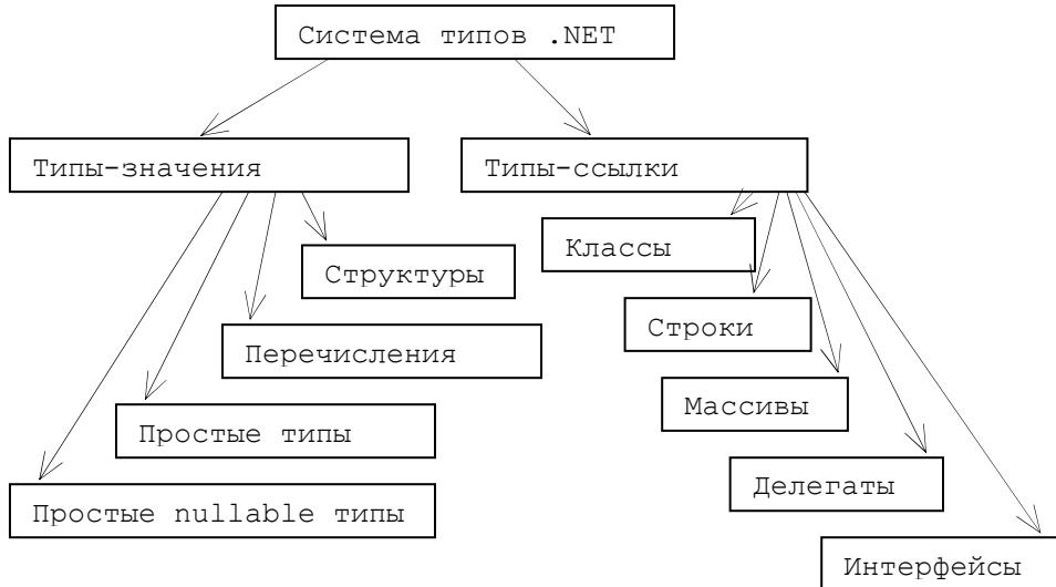
**Рис.1. Система типов .Net**
