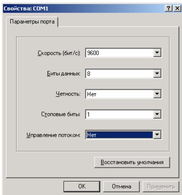
После выполнения этих действий соединение считается созданным. Его надо сохранить в меню программы HyperTerminal File→Save или Файл→Сохранить. После этого в меню, в котором находится программа HyperTerminal, появится папка HyperTerminal, в которой будет созданное соединение sdk5. При его запуске будет запускаться HyperTerminal с параметрами, введенными при создании соединения.
