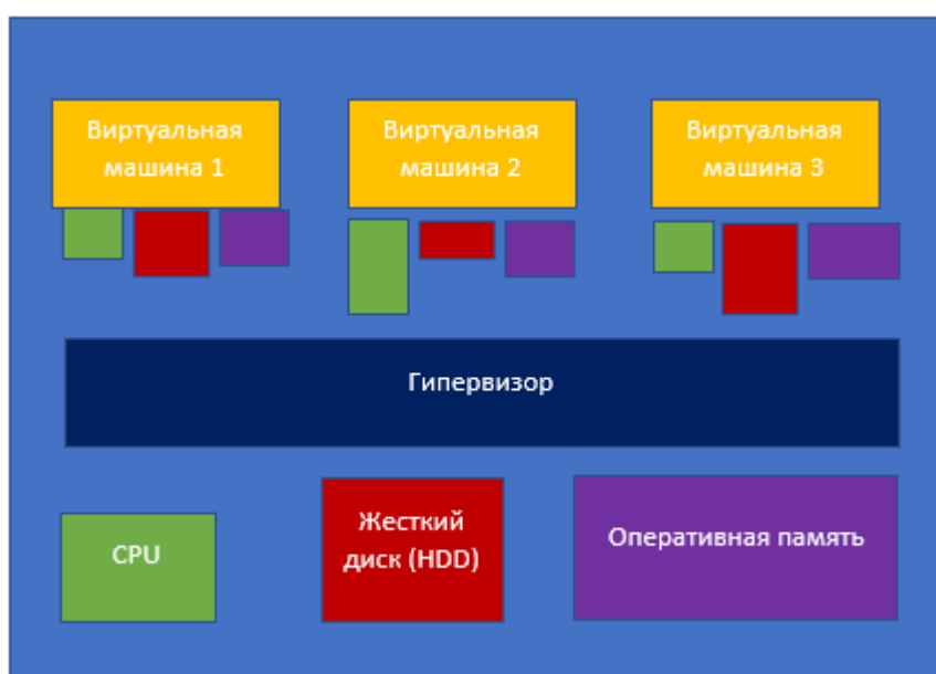
Рисунок “Роль гипервизора в координации доступа виртуальных машин к ресурсам”.
