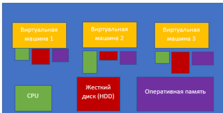
Рисунок “Разделение аппаратных ресурсов между виртуальными машинами”
