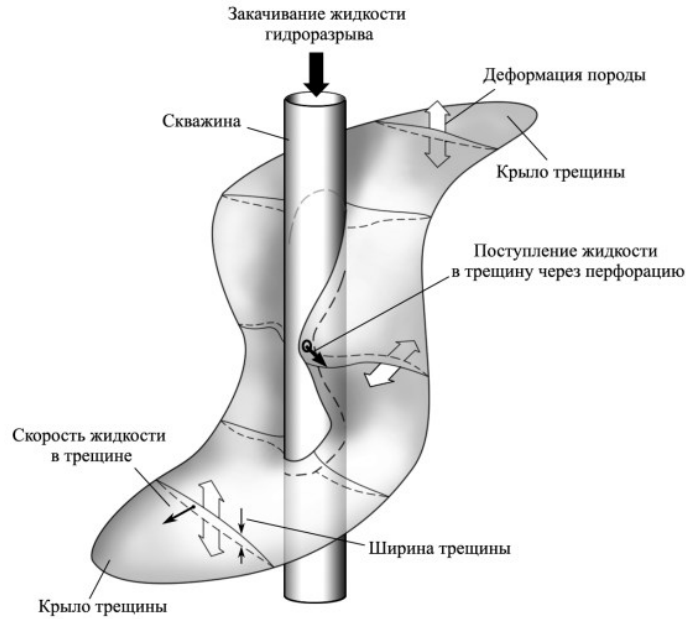
Рис. 1. Схематичная картина процесса гидроразрыва пласта
