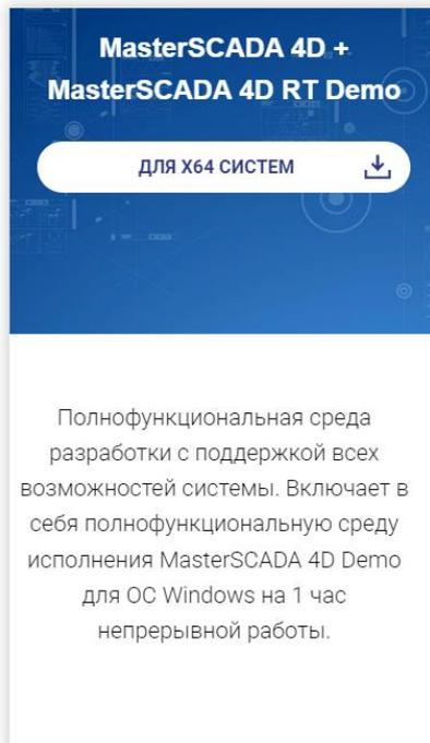
Данное приложение представляет из себя инструмент для разработки Scada систем, но также имеет и модуль программирования виртуальных контроллеров на языках программирования контроллеров, таких как: FBD, STL, LAD.
