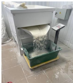
Рисунок 1 – Мукопросеиватель ВОСХОД ПВГ-600
