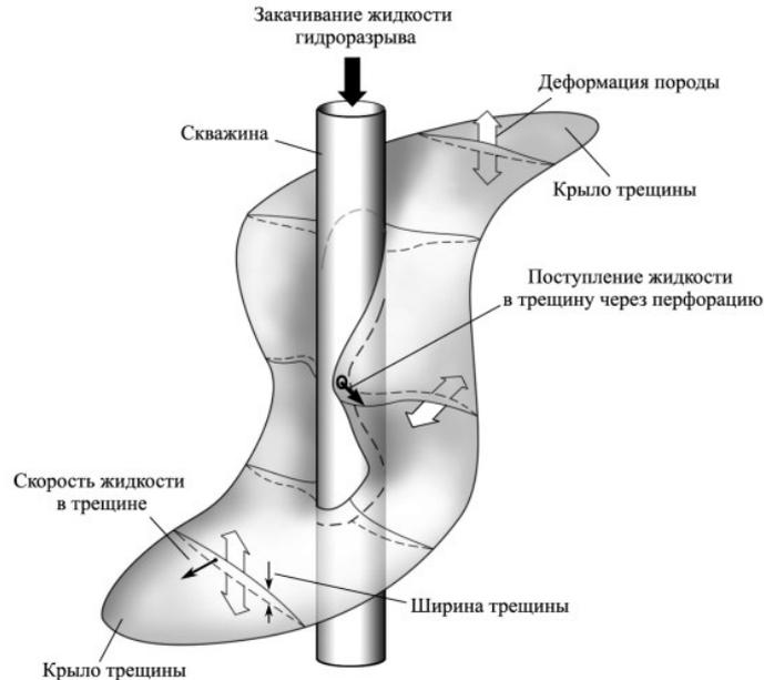
Рис. 1. Схематичная картина процесса гидроразрыва пласта
