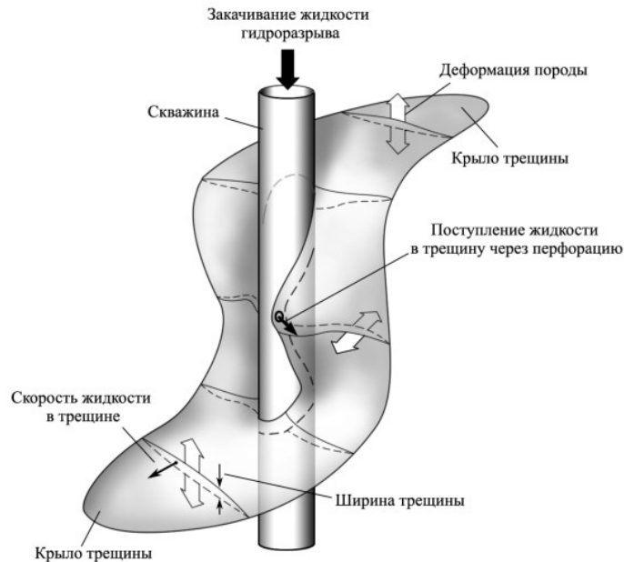
Рис. 1. Схематичная картина процесса гидроразрыва пласта
