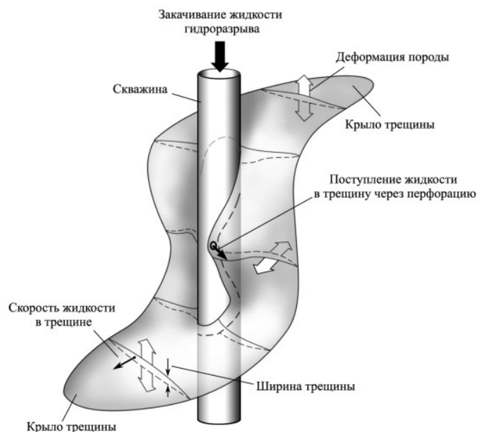
Рис. 1. Схематичная картина процесса гидроразрыва пласта
