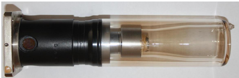
Рис. 14. Схема (а) и фотография (б) рентгеновской трубки. 1 – медное основание; 2 – «зеркало» анода; 3 – окна для выхода рентгеновских лучей; 4 – катод; 5 – фокусирующий колпачок
