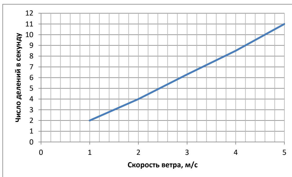
Рисунок 2. Градуировочный график для определения скорости воздушного потока от 1 до 5 м/с по анемометру АСО-3
